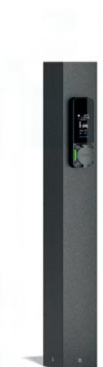
Pollerstandrohr aus korrosionsbeständigem Aluminium mit Aluminium-Druckguss Abdeckung, seewasserbeständig pulverbeschichtet. Mit voll umschlossenem Befestigungssockel aus Edelstahl. Masttür mit Dreikantschloss (SW 8). Ladeeinheit in separater Box aus Aluminium. Transparentes Kunststoff-Sichtfenster, zu öffnen über Schlüssellöcher zur Kontrolle/Prüfung von FI und Überspannungsschutz. Farbe silber (auf Anfrage).
