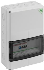
Kleinverteiler, 1-reihig mit integrierten Belüftungselementen zur Vermeidung von Kondenswasser, bauartgeprüft nach EN 61439-3, anschlussfertig verdrahtet auf Zu- und Abgangsklemmen 10mm<sup>2</sup>
