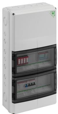
Kleinverteiler, 2-reihig mit integrierten Belüftungselementen zur Vermeidung von Kondenswasser, bauartgeprüft nach EN 61439-3, anschlussfertig verdrahtet auf Zu- und Abgangsklemmen 10mm<sup>2</sup>
